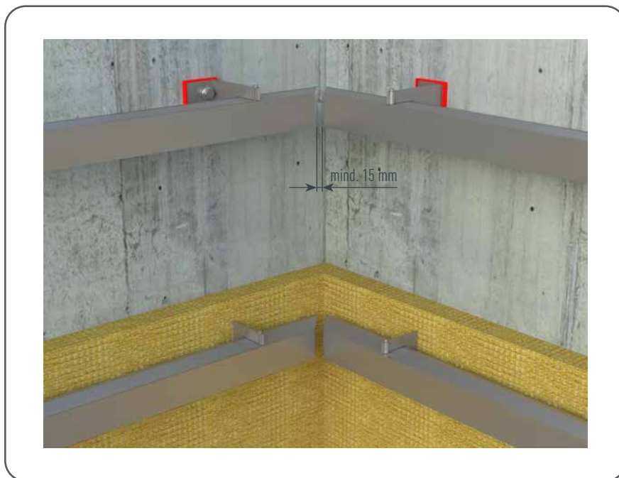
Abbildung 49 · Dehnungsabstand zwischen Tragprofilen
