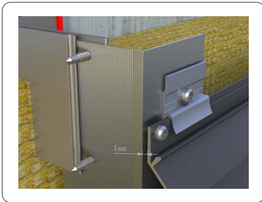
Abbildung 25 • Gleithaft-Montage auch bei Festpunkt
