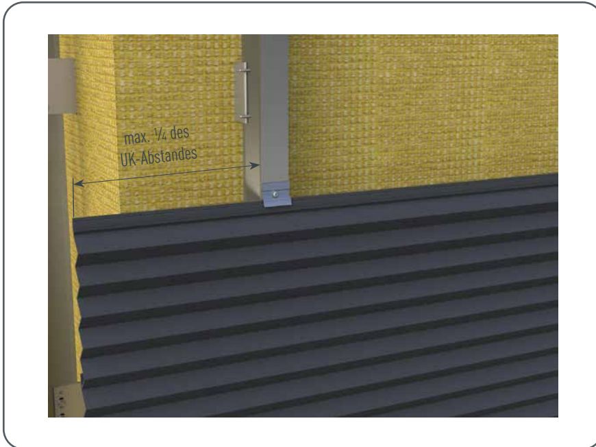
Abbildung 3 · Max. Auskragung der Strangpressprofile
