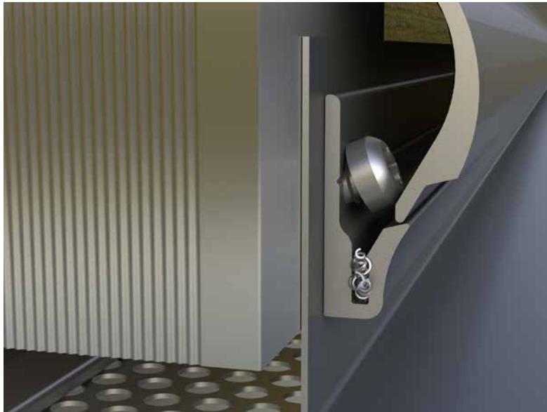
Abbildung 32 • Fehlerhafte Befestigung Startprofil
